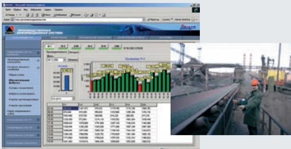
Автоматизированная система учета материальных потоков на ОАО "Лебединский ГОК" (Транспортно-поточная система, с 57 конвейерными весами, объединенными в единую информационную сеть)
