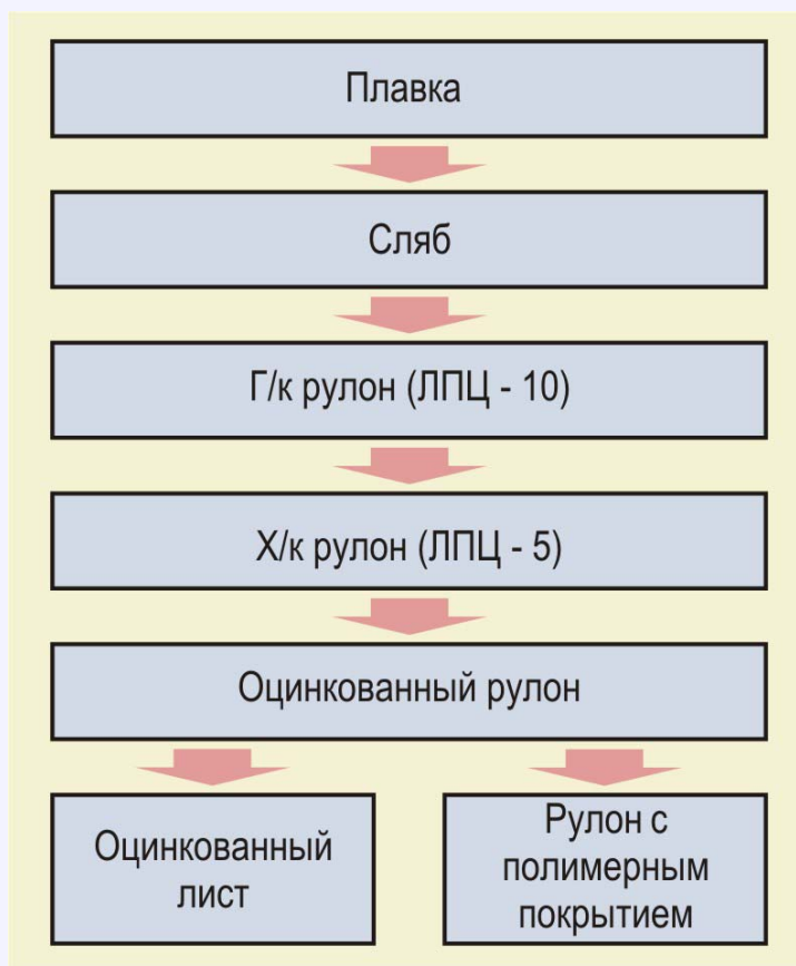
Рис. 1. Технологический маршрут производства оцинкованного металла и металла с полимерным покрытием в ОАО «ММК»
